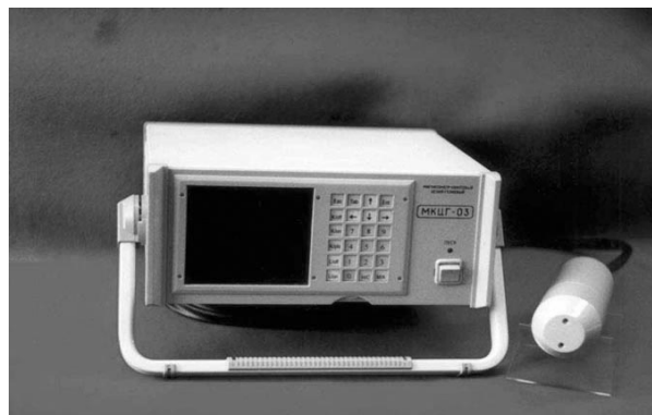
Fig. 4 MQCH-03 Cs-He magnetometer
